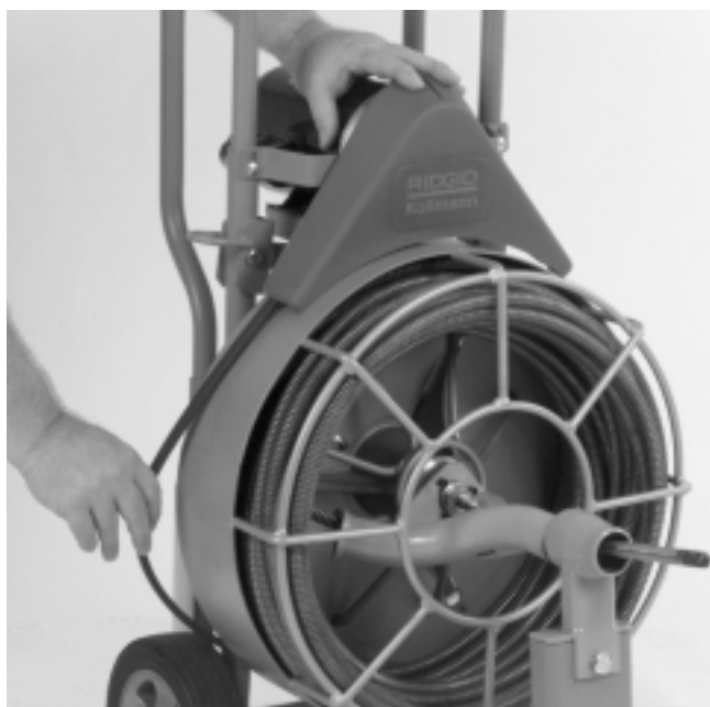
Figura 9 – Suelta la tensión de la correa
