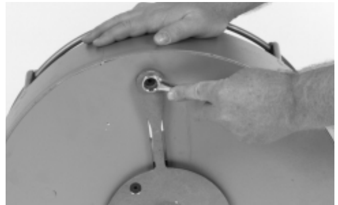
Figure 12 – Dépose du boulon de retenue de la queue de cochon
