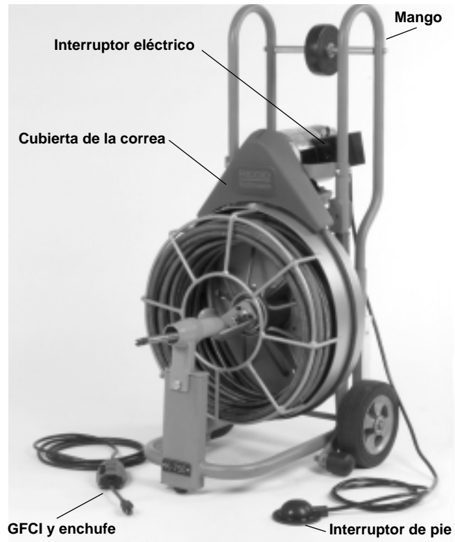
Figura 6 – Limpiadora de desagües K-750R
