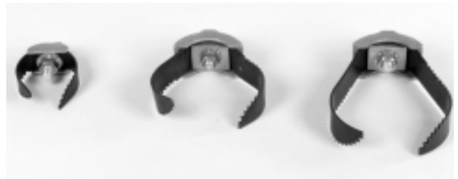
Figure 4 – Mèches de curage T-411 (2"), T-413 (3") et T-414 (4") pour curage général et élimination des racines d'arbre et autres matériaux accrochés aux parois des canalisations
